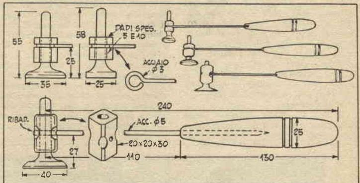
1. - prendere un blocchetto di acciaio, farvi un foro longitudinale nel quale possa essere introdotta a forza la parte dell'albero della valvola ancora unita alla testa; introdurre a forza questo manicotto nell'asta della valvola, quindi forarlo insieme all'asta stessa trasversalmente; introdurre nel foro il tondino del manico, ribattendone la estremità sporgente e bloccare il tutto con saldatura ad argento.
