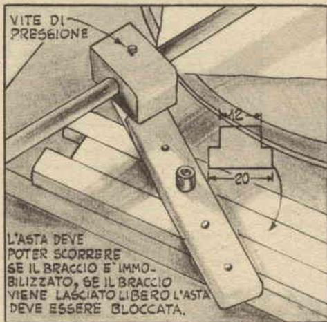
Il blocco-perno del braccio scrivente è illustrato nelle fig. 6, 7, 8: notate che al braccio può essere consentito di scorrere liberamente nel blocco-perno, se questo è immobilizzato, mentre deve essere bloccato, se il perno è libero di roteare come in fig. 8: si sceglierà l'un sistema o l'altro a seconda dei risultati che si vogliono ottenere, e la pratica sarà al fine di tale scelta la migliore maestra.
