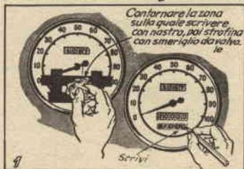
PER ricordarvi il chilometraggio limite per il cambio dell'olio o la rotazione degli pneumatici, scrivete il numero con una matita su di un rettangolino del vetro del contachilometri, opportunamente smerigliato. Per la smerigliatura, circondate l'area da smerigliare con nastro adesivo e strofinare con smeriglio da valvole.
