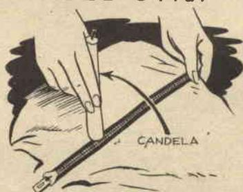
Se la slitta di una serratura lampo non scorre bene, provate a passare leggermente sul metallo una candela di cera: ne prolungherete la vita, mentre ne migliorerete il funzionamento.
