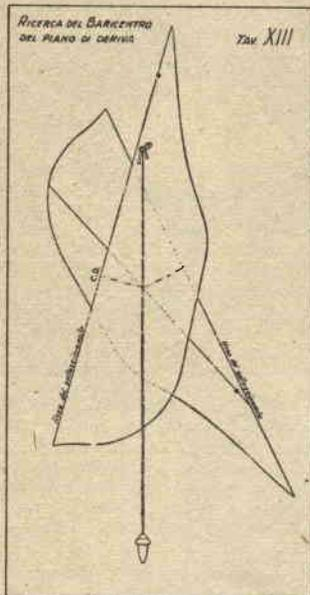
13. Piano di Deriva. — Per poter disegnare il piano di velatura ci occorre di conoscere prima il piano di deriva e determinare di esso il centro di gravità. Con le misure in centimetri che vi fornisce la tav. II, costruite su cartoncino la figura che sta sotto la linea di galleggiamento, dalla sezione 0 alla sezione 10. (vedi Tav. XIII).
