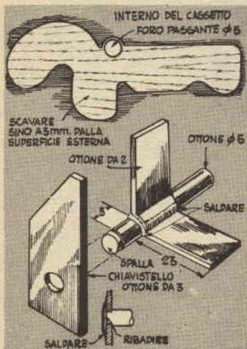
SE il ladro od il curioso non avranno pensato a provvedersi di un magnete, e se non sapranno la maniera precisa di usarlo, questa serratura sfiderà tutti i loro sforzi, nonostante che per la sua costruzione non siano necessarie che due sferette di acciaio, ricavate da un vecchio cuscinetto, oltre ad un po' di lamiera di ottone e qualche centimetro di tondino, di ottone anch'esso: non usate comunque materiali ferrosi, se non per le due sfere.
