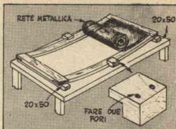
e che la rete metallica resisterà abbastanza alla ruggine se sarà di filo di acciaio galvanizzato, e non temerà affatto l'ossidazione, se di rame o di ottone.
